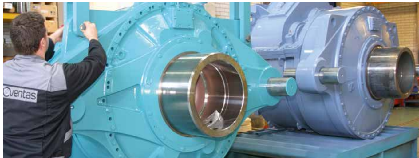
Elektros varikliai dengti dažais „Fontecoat EP 80“
