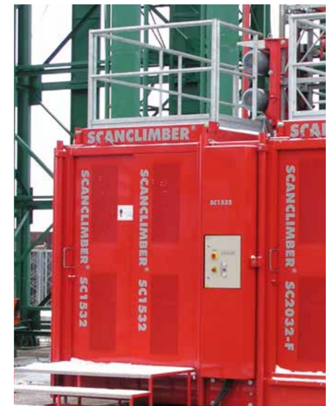
Bokštinės darbinės platformos dengtos gruntu „Temanyl PVB“ bei „Temacoat GPL-S“ ir dažais „Temathane PC 80“
